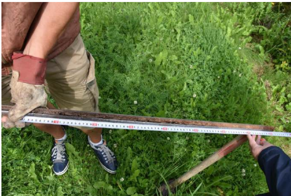
20.att. Augšnes horizontu noteikšana ar mērlentu
