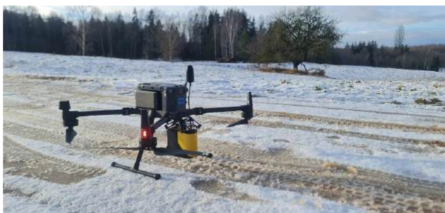
60.att. DJI Matrice 300RTK ar YS mapper lazerskenneri
